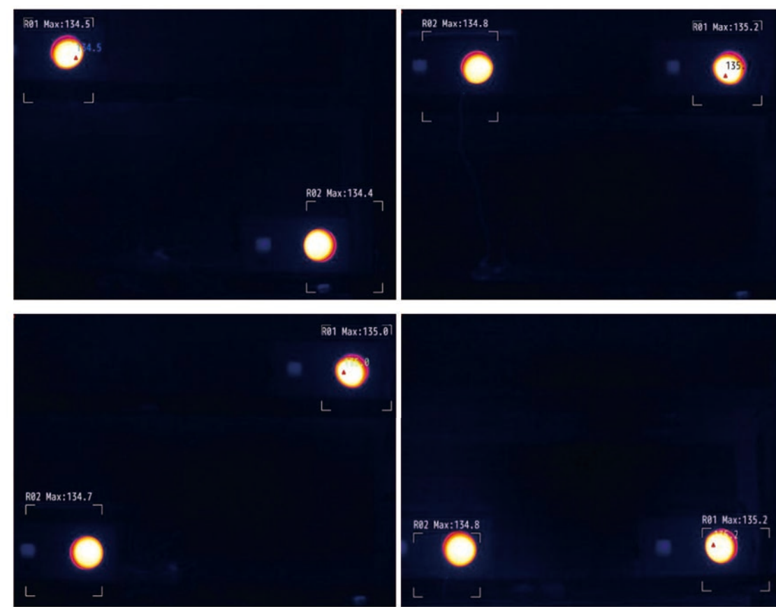
将同一型号的两个黑体设置相同的温度，用H60测其任意两点的温度，H60测温结果显示任意两点温差小于0.5k
