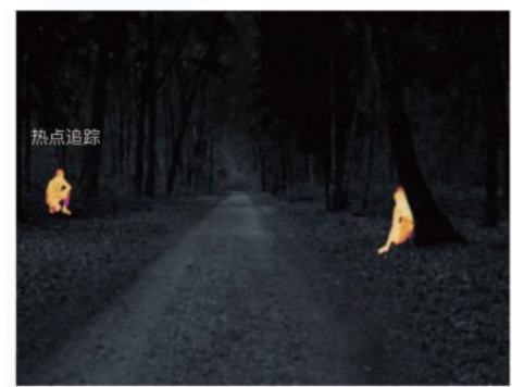
用于发现热点，现场温度最高的20%区域 热点探测
